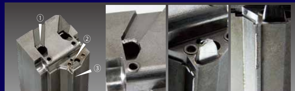
①コーナーエッジ ②薄肉部 ③パーティングライン
