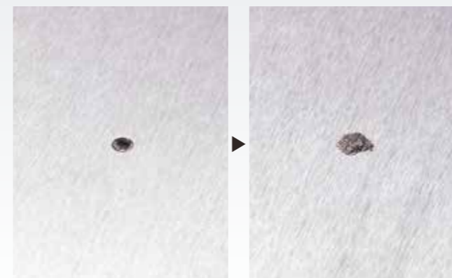
▲ピンホールの補修
