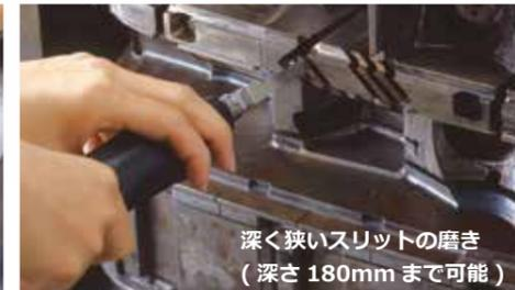
R 面から平面、広い面の磨きをロータリー研磨で処理し、微細な奥隅の研磨を超音波で行うことができます。研磨装置を使い分けることなく、この一台で対応可能です。
